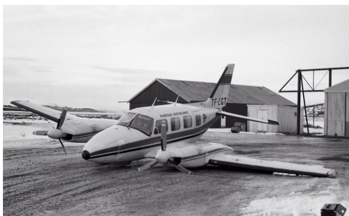
Verulegt tjón varð á einni af þremur tveggja hreyfla áætlunarvélum Flugfélags Austurlands í febrúar 1990. Vinstra aðalhjól og nefhjól TF-EGT fóru úr læsingu með þeim afleiðingum að vélin hlukaðist niður. Austramynd.
